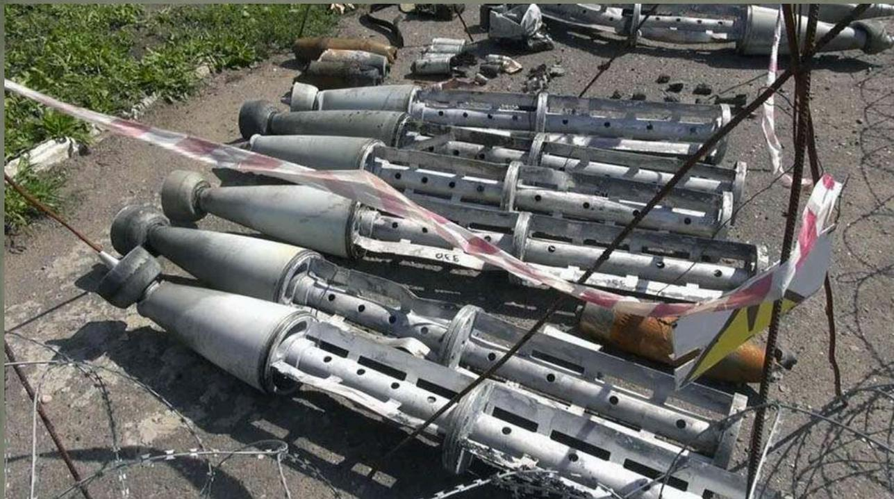
Ракета РЗСО «Ураган» несет на себе 30 боевых кассет с поражающим элементом. Часть боевых кассет, после произведения выстрела, могут находиться во взведенном состоянии, неразорвавшиеся. Таким образом представляют большую угрозу жизни и здоровью.
